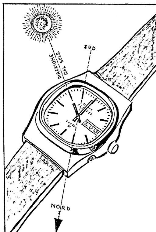
Fig. 28 - Sono le 10. Posta la lancetta delle ore in direzione del sole, nella direzione 5 (10:2) si avrà il Nord.
