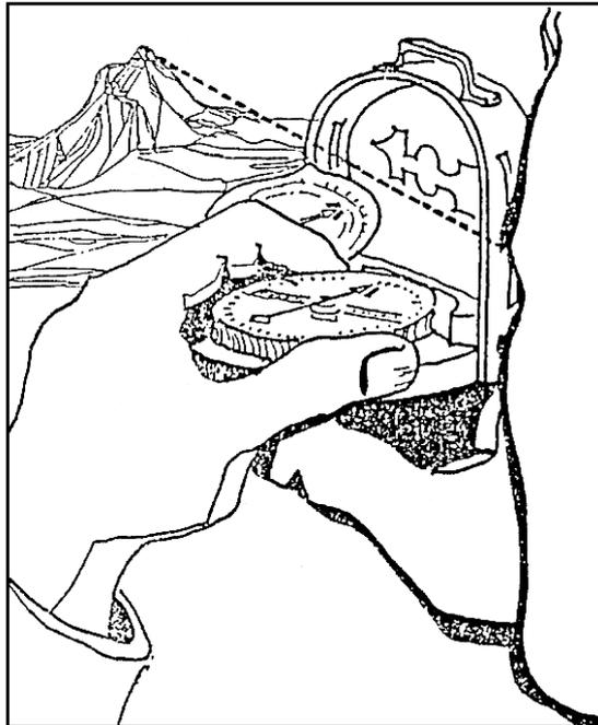
Fig. 21 - Rilevamento di un azimut per mezzo della bussola Bezaard.
